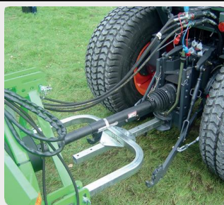
แถบลากเพื่อใช้กับเพลลา pto มุมกว้าง และ / หรือแปรงไฮดรอลิกสำหรับทำความสะอาดถนนด้านข้าง (อุปกรณ์เสริม)
