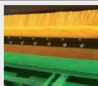
แปรงชนิดต่างๆ: ขนอ่อนสำหรับเก็บเศษใบไม้ ขนแข็งสำหรับเก็บเศษวัสดุหนัก
