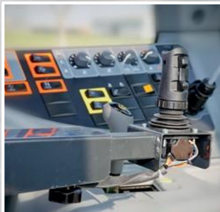
ระบบสั่งการภายในห้องโดยสารด้วยจอยสติ๊ก Parker 4 แกนและหน่วยควบคุมแบบตัวโปรแกรมได้
