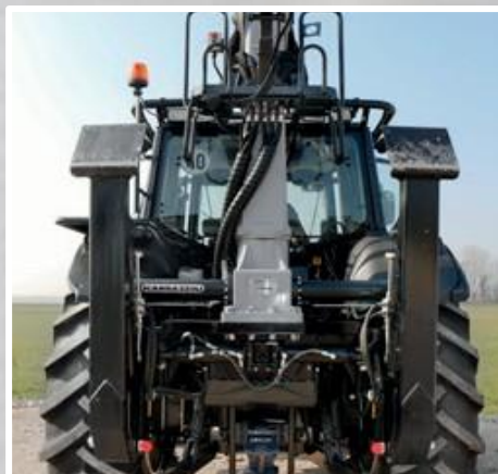
มุมมองด้านหลังพร้อมโหมดเตรียมการและซิด ICAR และตัวปรับเสถียรภาพแบบปรับได้
