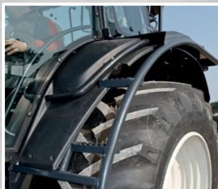
บันไดทางเข้าที่รวมเข้ากับบิวโรคลนรถแทรกเตอร์
