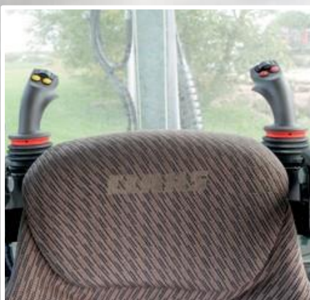
สั่งการภายในห้องโดยสารด้วยจอยสติ๊ก Dan-foss
